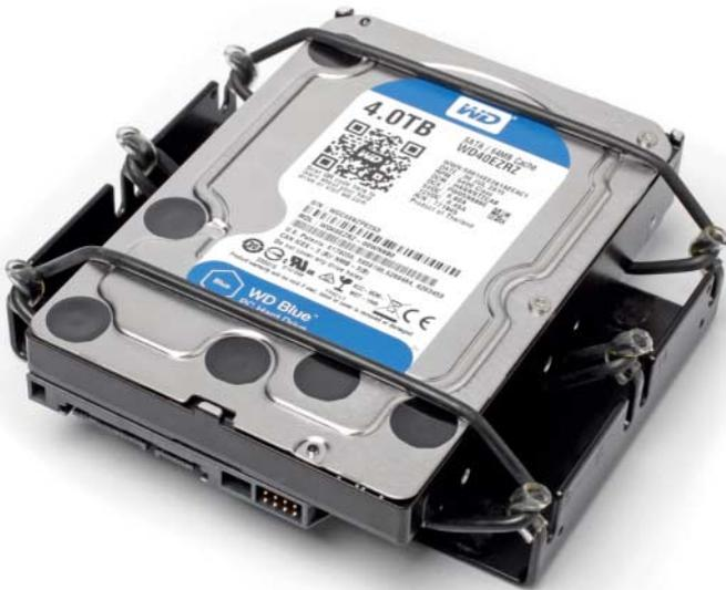
Der Entkopplerrahmen verhindert, dass es bei Plattenzugriffen in der Kiste rappelt.
