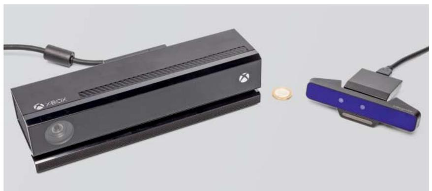
Die Kinect-Kamera der Xbox One (links) lässt sich für Windows Hello verwenden, ist aber extrem klobig, schwer und noch dazu mit einem Lüfter ausgestattet. Die 3D-Kamera RealSense SR300 (rechts) aus Intels RealSense-Developer-Kit hat hingegen herkömmliche Webcam-Abmessungen.
