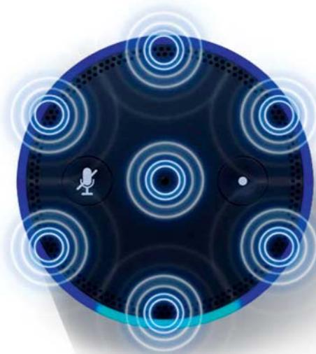
**Gespitzte Ohren: Ein aus sieben Mikrofönen bestehendes Array sorgt dafür, dass Echo (Dot) auch leise Sprachbefehle erlauscht.**
