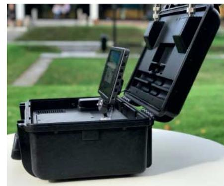
**Die transportable Version von AeroScope nutzt als Monitor ein DJI CrystalSky. Das Touchscreen-Display hat eine Diagonale von 7,85 Zoll und löst mit 2048 x 1536 Pixeln auf.**
